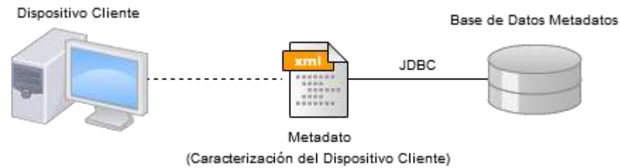
Figura 3-37. Extracción de las características del dispositivo cliente
