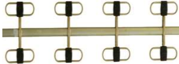
Figura 1.17. Arreglo de antenas dipolo de forma elíptica
