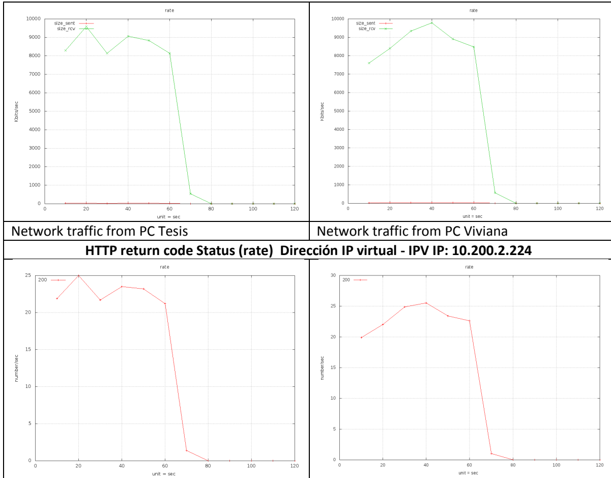
Figura B.12 (b) Resultados Obtenidos de la Herramienta de Prueba de Stress Tsung durante la prueba 6 de disponibilidad a la solución tecnológica Haproxy-Keepalived
