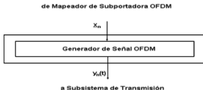
Figura 2.10 Diagrama de Bloques del Generador de Señal OFDM.
