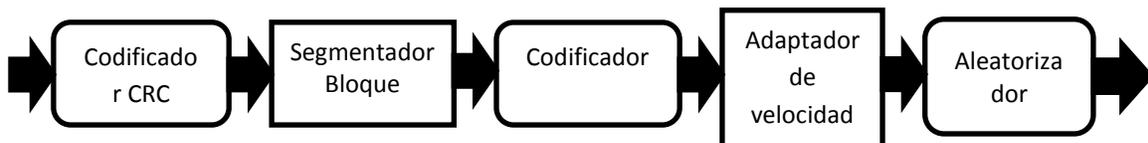
Figura 3.13. Bloques internos del codificador.
