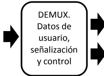
**Figura 3.24.** Demultiplexor de datos de usuario, señalización y control.
