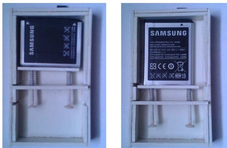
Figura B.4: Conexión del conector en 2 diferentes tamaños de batería - Herramienta hardware.
