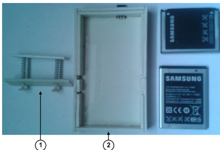
Figura B.3: Partes del conector para batería - Herramienta hardware.
