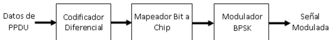
Figura 1.8 Funciones de modulación y ensanchamiento con BPSK y DSSS
