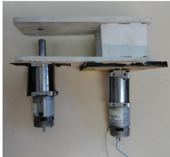
Figura 3.24. Segunda articulación con los motores.
