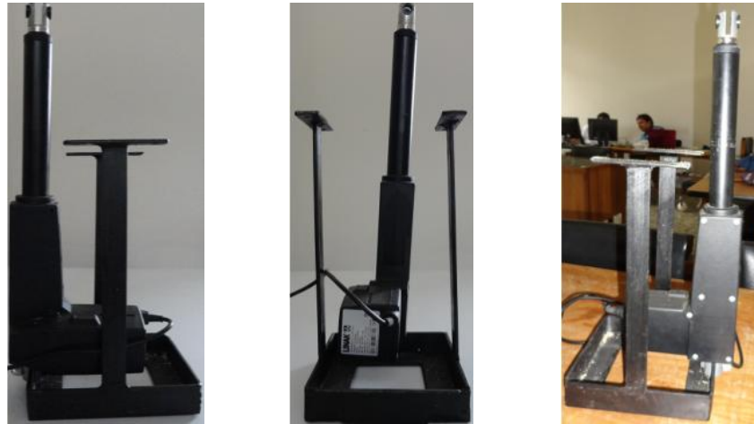
Figura 3.17. Distintas vistas de la base metálica del primer actuador.
