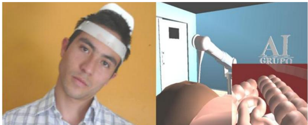
Figura 2.17. Casco y ambiente virtual que conforman el dispositivo auxiliar de mando del robot Hibou [45].
