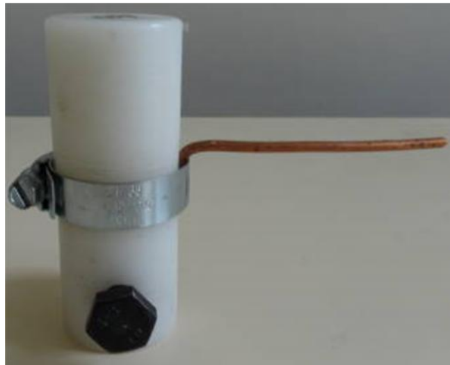
Figura 5.2 Buje adaptado para que funcione con el potenciómetro deslizable
