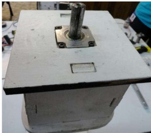
Figura 3.23 Motorreductor protegido completamente por la caja.
