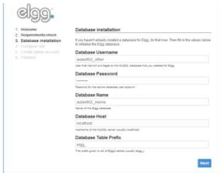
Figura B.4. Instalación base de datos
