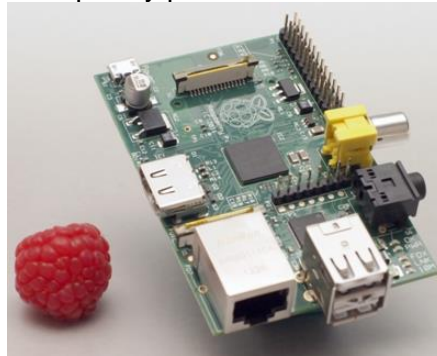
Figura 1.10. Primer modelo de Raspberry para Simulink®
