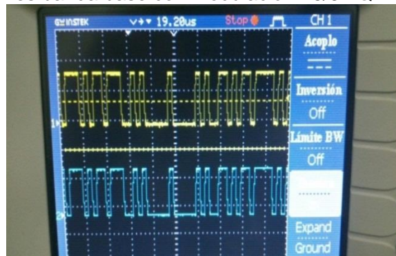
Figura 2.118. Señales de entrada y salida obtenidos a partir de implementación, sistema básico de comunicaciones banda base con modulación 16/64 QAM
