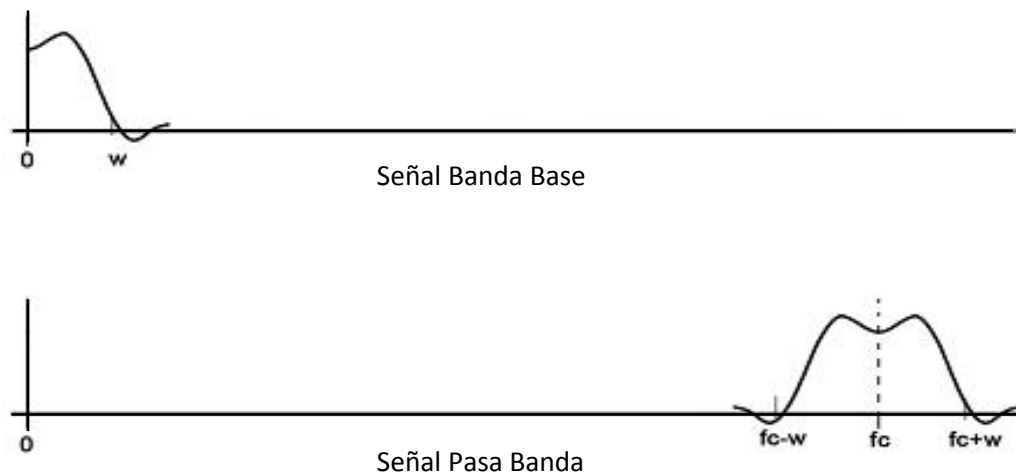
Figura 1.4. Traslación lineal espectral
