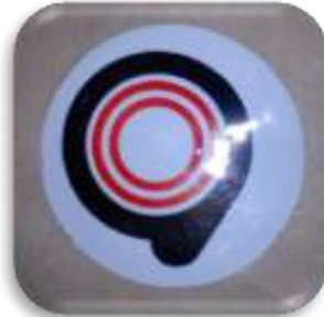
Figura 4.7. Etiqueta Mifare Logo Type 2 Sticker Ultralight C Circle (25mm diámetro). Fuente propia.
