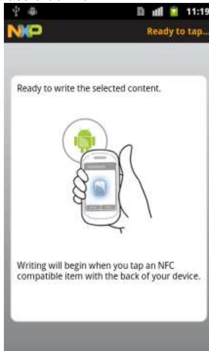
Figura E.19. Colocar la etiqueta NFC en la parte trasera del móvil.
