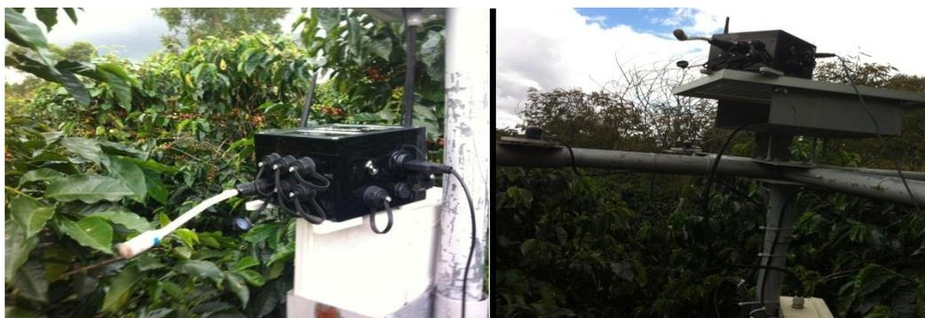
**Figura 5. 11 Nodo sensor de temperatura y Humedad (Fuente Propia)**
