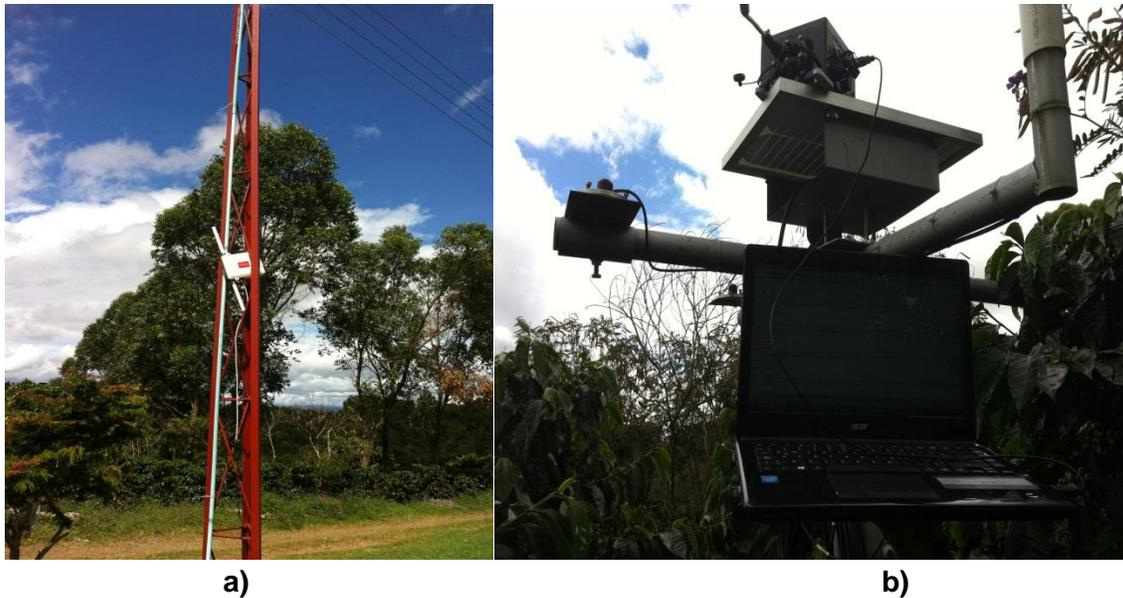
**Figura D. 12 Nodo sensor de temperatura y Humedad**
