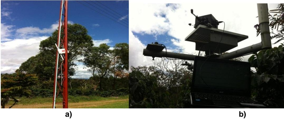
Figura D. 9 Nodo sensor de temperatura y Humedad
