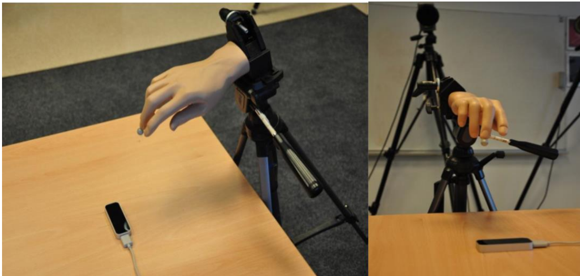
Figura 1.8. Sistema para análisis de LeapMotion basado en captura óptica de QualisysTrack. Tomado de [24]
