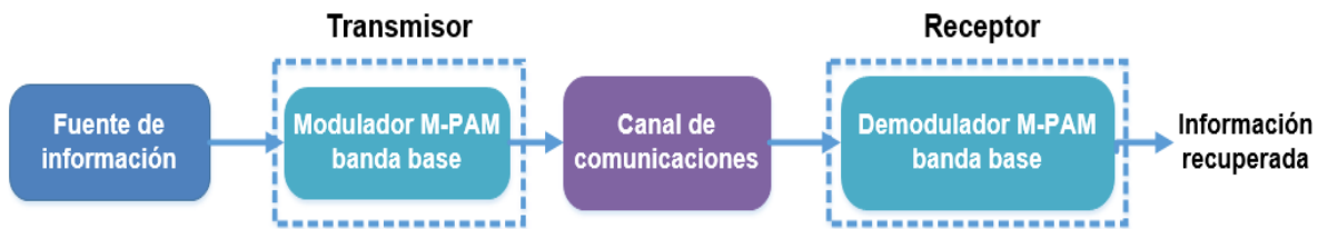
Figura 1.1. Diagrama general de un sistema de comunicaciones banda base con modulación M-PAM.
