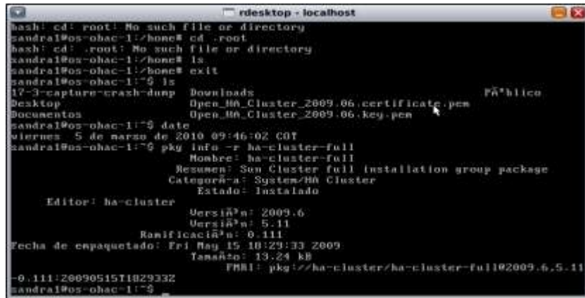
Figura 29D. Verificación de la instalación de HA Cluster
