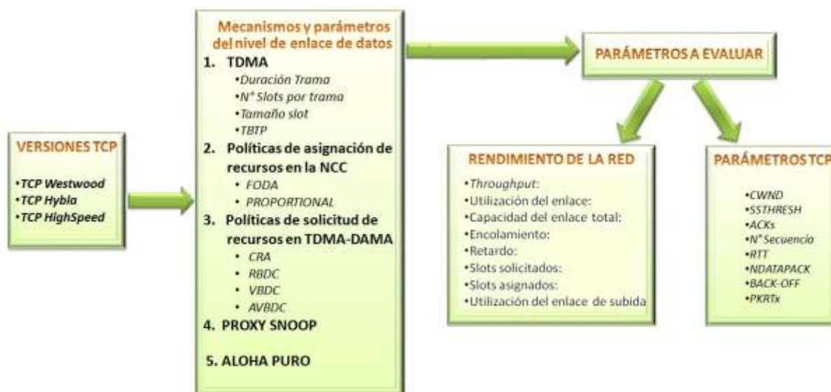
Figura 3-3. Estructura empleada para analizar el impacto del protocolo TCP al variar los parámetros de los mecanismos del nivel de enlace de datos.
