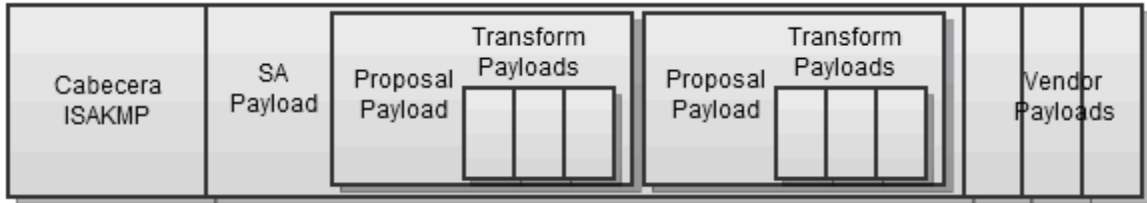
FIGURA 1. 6 PAQUETE EN MODO PRINCIPAL (IKE) O DE PROTECCIÓN DE LA IDENTIDAD (ISAKMP)
