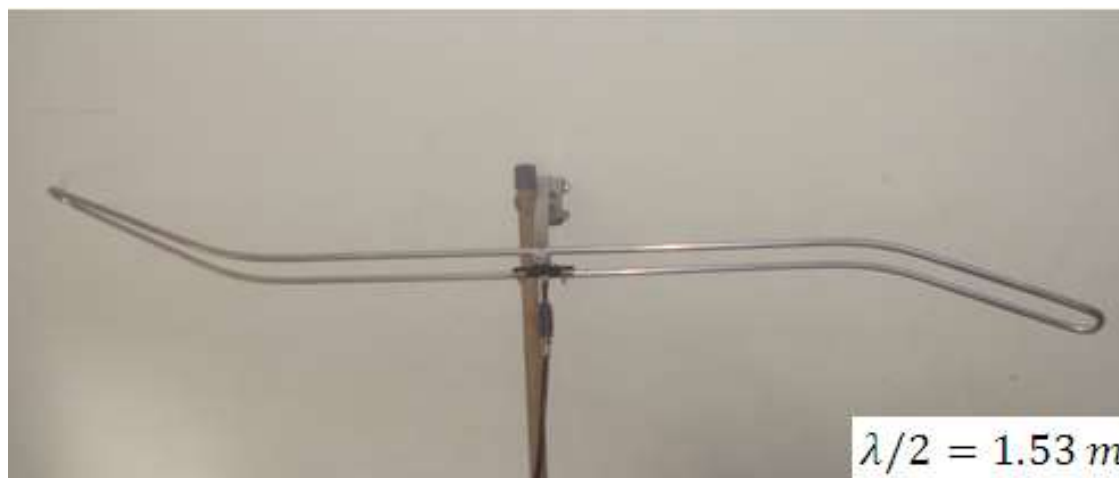
Figura 4.3. Dipolo Plegado de Lambda Medios.
