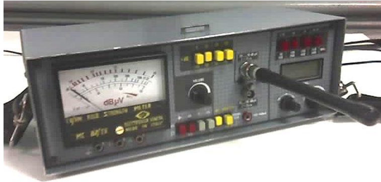
Figura A.46. Medidor de intensidad de campo y antena Yaesu para FT411.
