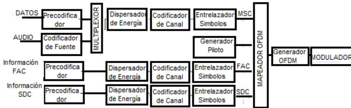
Figura 1.5 Diagrama en Bloques del Transmisor DRM [3]
