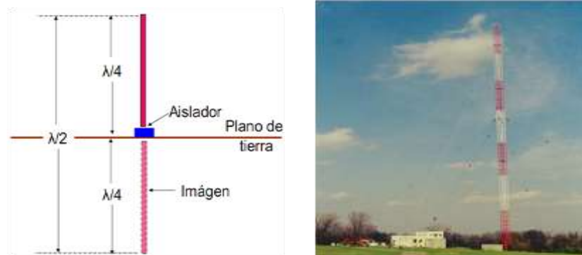
Figura 4. Antena Dipolo de \lambda/2 en MW 3
