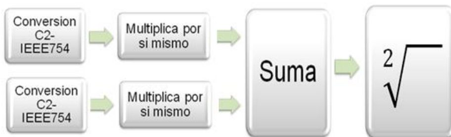
Figura 3.10. Modulo para obtener magnitud de la señal en el dominio de la frecuencia.
