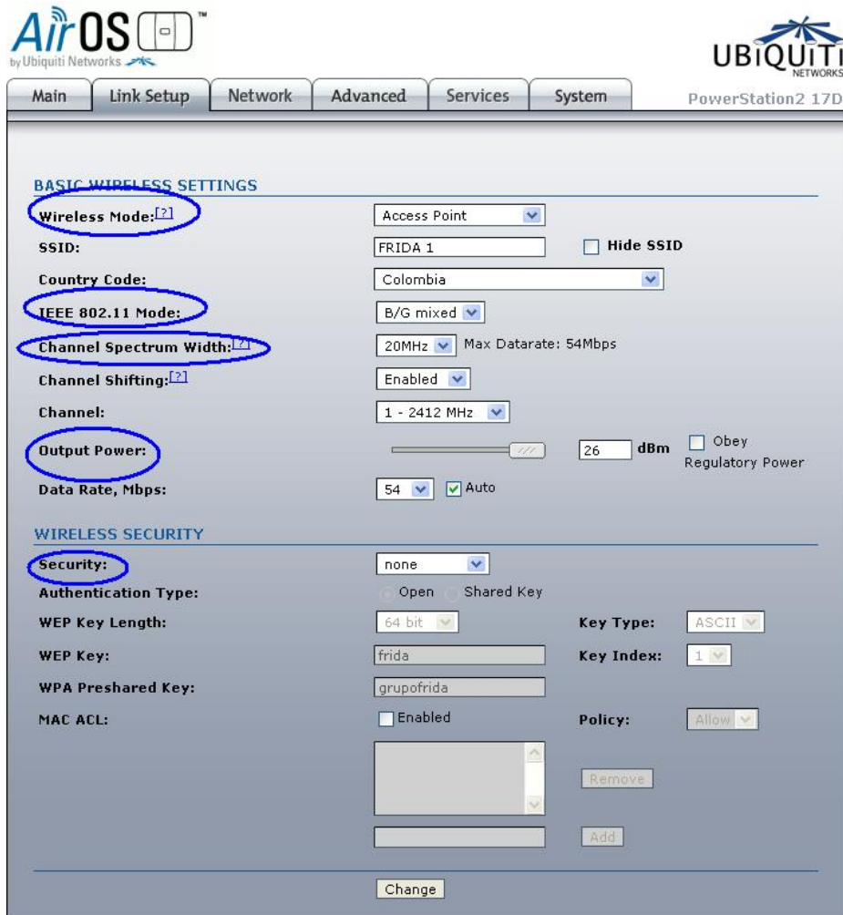
Figura 28. Identificación de Parámetros en Configuración Inalámbrica.
