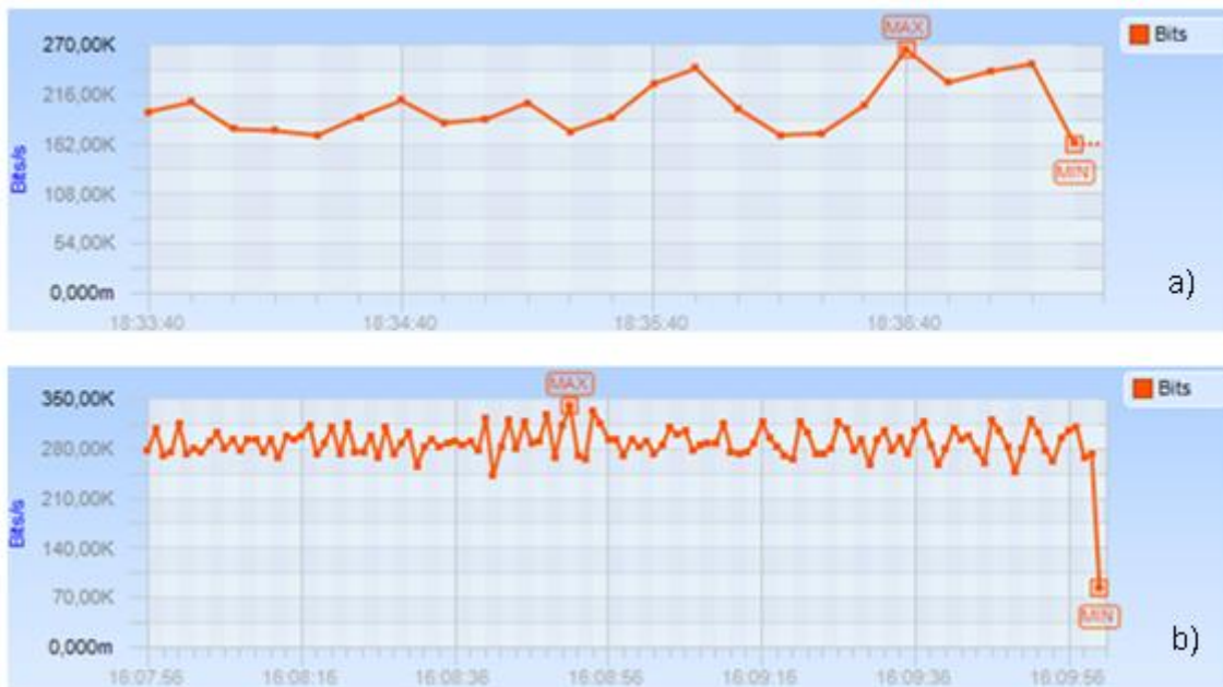
Figura 55. Ancho de Banda para el Modo de Red, a) Bridge y b) Router .
