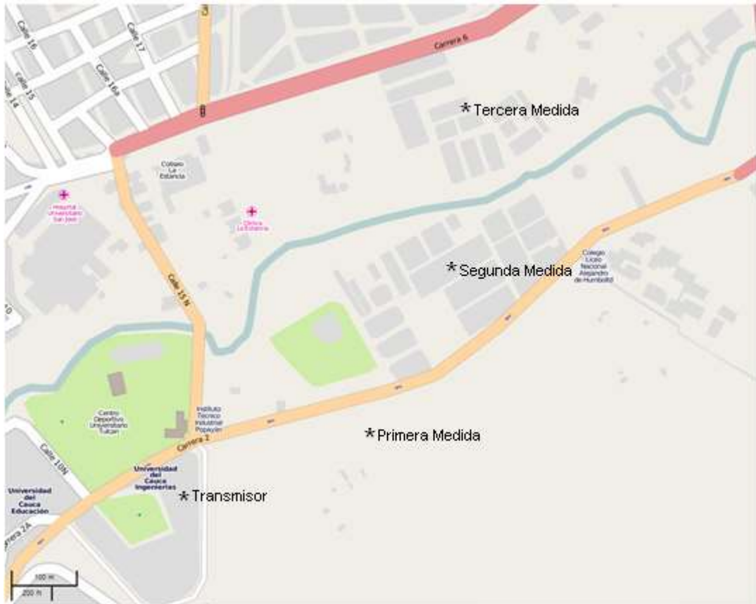
Figura 4.34 Ubicaciones del Transmisor y Receptor para la Medida de la BER
