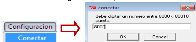
Ilustración C-6: Ventana de configuración del puerto del MSOX
