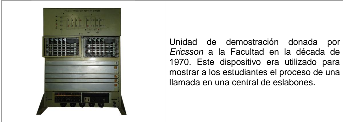
Figura B.8: Bastidor de demostración de un Sistema de Eslabones – Actividad Museo FIET. (Fuente Propia).
