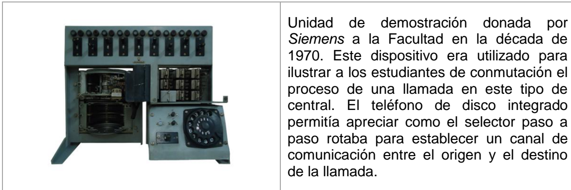
Figura B.2: Bastidor de demostración de la central EMD – Actividad Museo FIET. (Fuente Propia).
