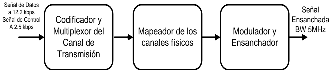
Figura 2.9 Estructura del subsistema BS en modo transmisión.
