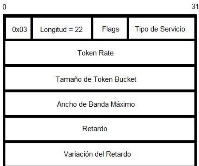
Figura 3.3 Formato opcional de QoS que contiene la especificación del flujo [3].
