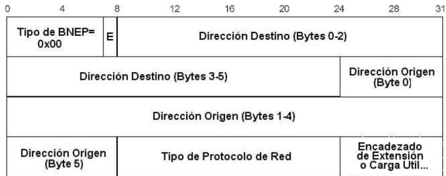
Figura 2.4 Formato del Encabezado para un paquete *BNEP\_GENERAL\_ETHERNET* [8].
