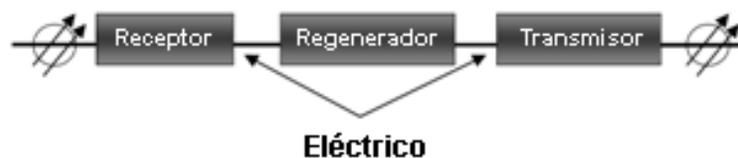
Figura 1. Amplificación opto-eléctrica-óptica [3]
