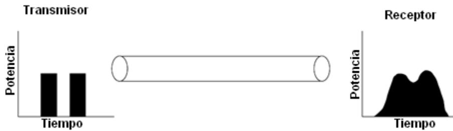
Figura 12. Resultado del ensanchamiento de los pulsos en el dominio del tiempo a causa de la dispersión [7]
