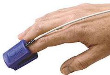
Figura 2. 9. “Adult Finger Clip” - 8000AA”, y especificaciones técnicas [54].
