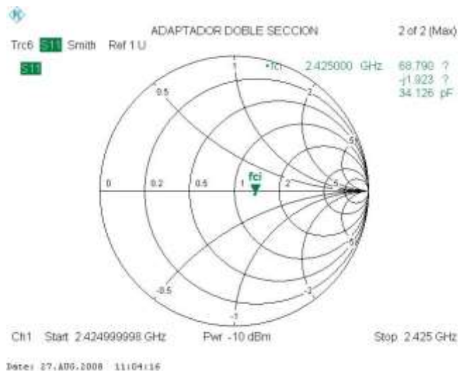
Figura 4-7. Respuesta del adaptador de sección doble medida en el analizador vectorial de redes a una frecuencia puntual de 2,425 GHz
