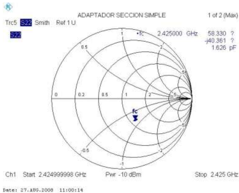
Figura 4-3. Respuesta del adaptador de sección simple medida en el analizador vectorial de redes a una frecuencia puntual de 2,425 GHz
