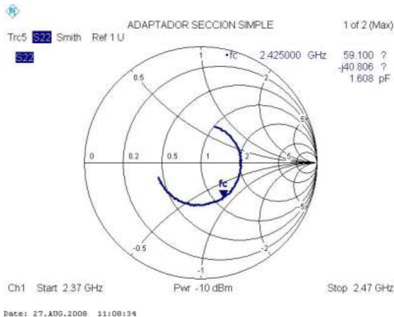
Figura 4-4. Respuesta del adaptador de sección simple medida en el analizador vectorial de redes en un rango de frecuencias (2,37 - 2,47 GHz).
