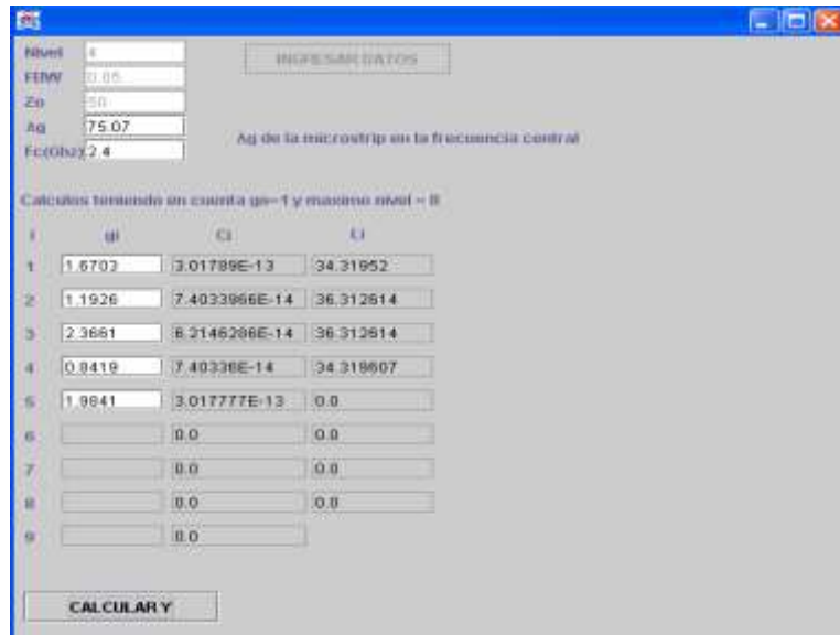
Figura 29. Parámetros del filtro Chebyshev con 0,5 dB de igual rizado de 2,34 – 2,46 GHz con resonadores acoplados capacitivamente.
