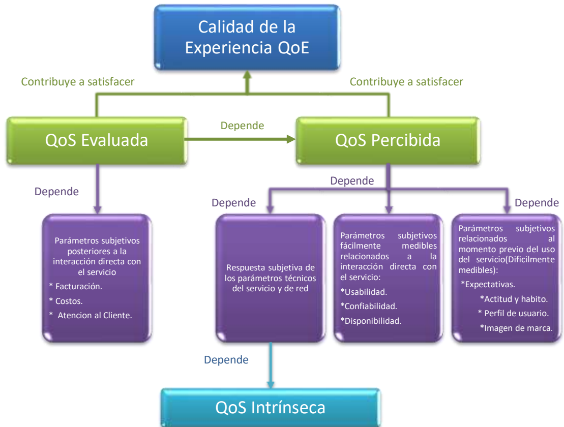
Figura 13. Relación de los niveles de calidad y los parámetros que afectan un servicio.
