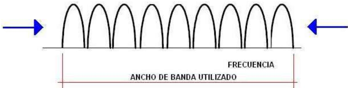
**Figura 3. Eliminación de la Banda de Guarda en la Multiplexación en Frecuencia**
