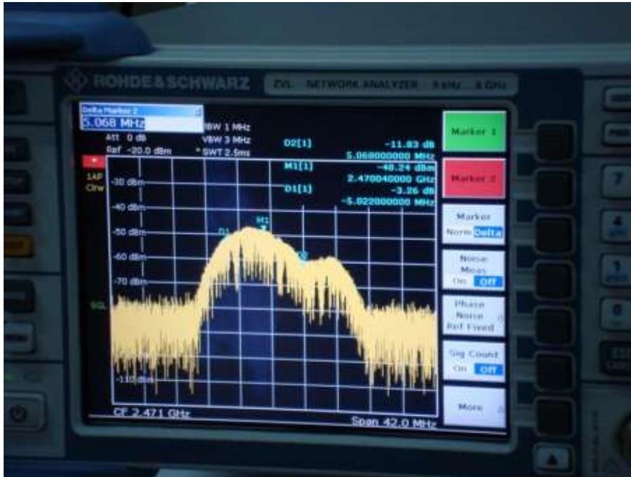
Figura E-3 Espectro portadora Canal 13 WiFi 802.11b, posterior a ajustes
