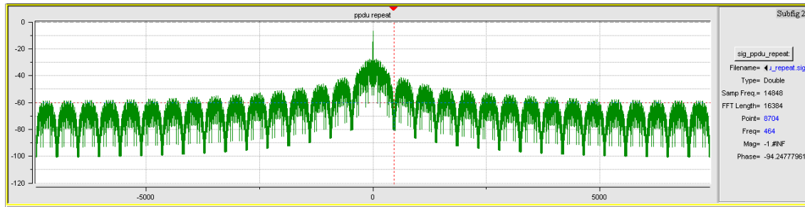
Figura 78. Respuesta en Frecuencia de la Trama PPDU.
