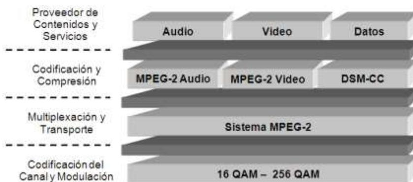
Figura 2-1. Arquitectura para la difusión de televisión digital en redes de cable
