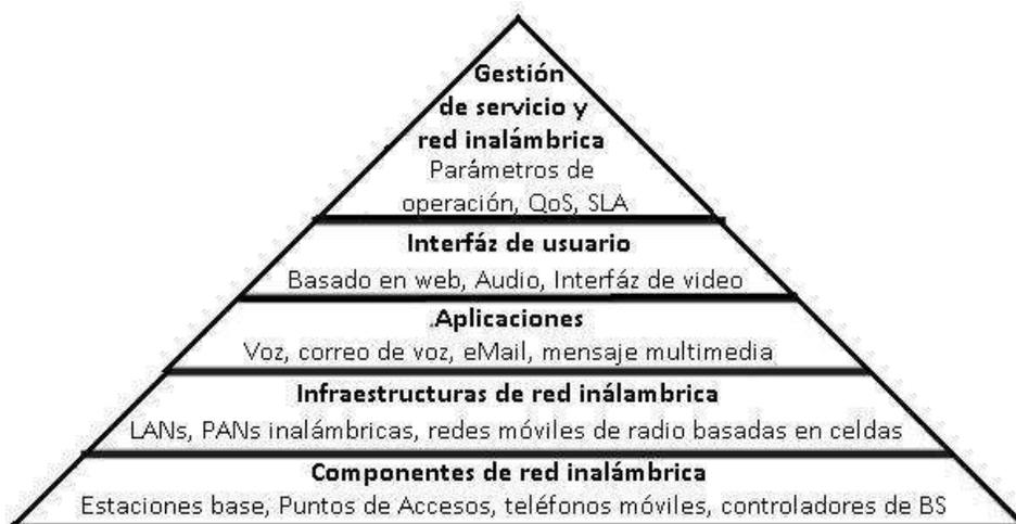
**Figura 1.12.** Estructura de convergencia de alto nivel
