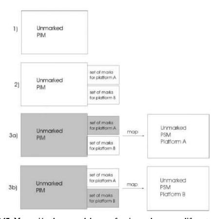
Figura 2.17. Marcación de un modelo para funciones de mapeo diferentes para dos plataformas distintas
