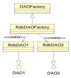
Figura 4.13. Patrón de Diseño DAO de la arquitectura J2EE
