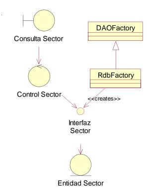
Figura 4.14 Estructura de clases con la aplicación del patrón DAO
