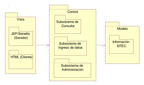
Figura 4.8. Arquitectura de referencia del Sistema Central para el ingreso manual de datos vía Web
