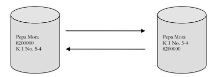
Figura 3.2. La replicación de datos es el simple intercambio de información entre bases de datos
