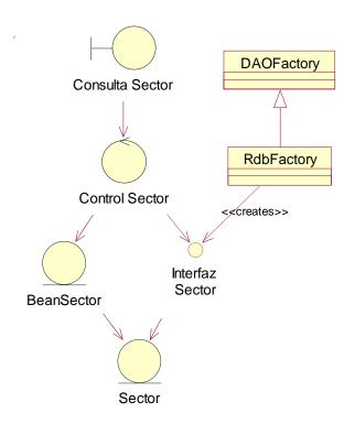
Figura 4.16 Estructura interna de clases de los paquetes de la aplicación. PIM parcial de diseño del subsistema de consulta.
