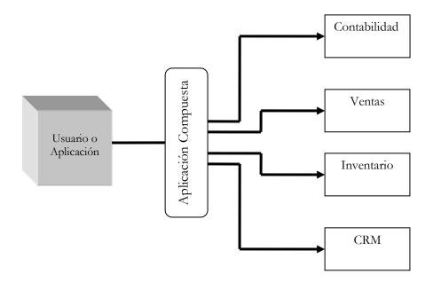
Figura 3.9 Una aplicación compuesta es la integración de muchas aplicaciones remotas en una sola aplicación
