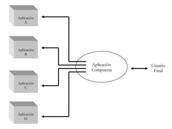
Figura 3.6. La Integración de Aplicaciones Orientadas al Servicio provee mecanismos para crear aplicaciones compuestas, utilizando servicios encontrados en muchos sistemas remotos
