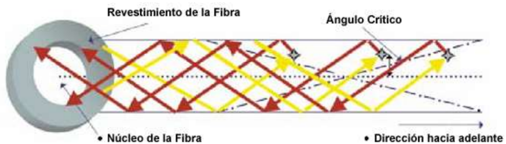
Figura. 2.2 Centros de Dispersión en el núcleo de la Fibra
