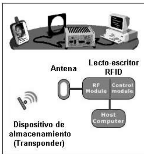
Figura 10. Elementos de un sistema RFID.
