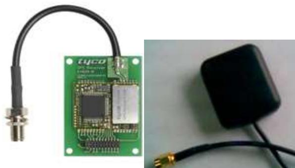
Figura 17. GPS Tyco y Antena WiseWave
