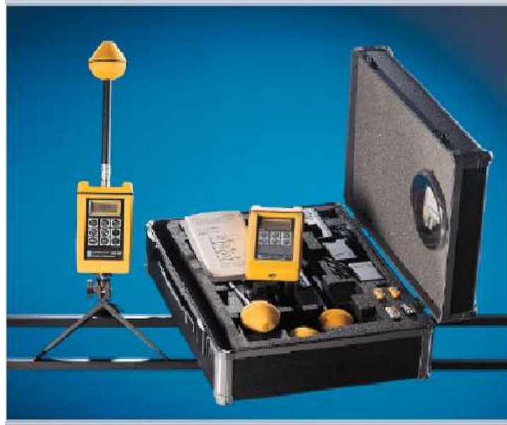
Figura 4.1 - Analizador de Campos Electromagnéticos Narda SRM 3000
