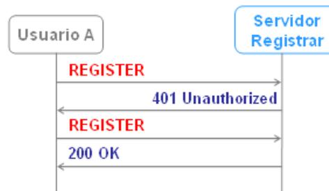
Figura A6: Registro mediante mensajes SIP
