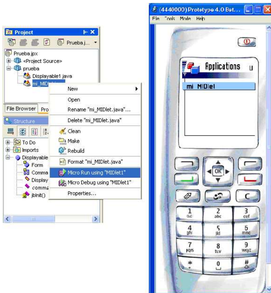
Figura 29. Emulación de una aplicación J2ME en JBuilder.
