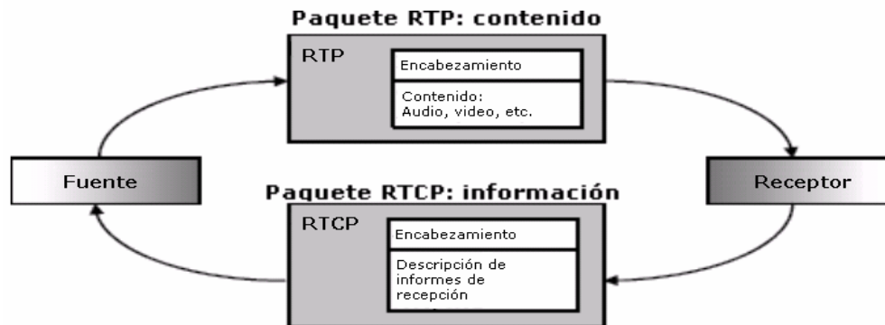
Figura 1-22. Paquetes RTP y RTCP para el control de la calidad en recepción
