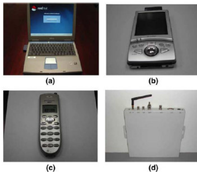
Figura 1-8. Ejemplos de clientes de la malla: (a) Portátil, (b) PDA, (c) Teléfonos IP y (d) Wi-Fi RFID
