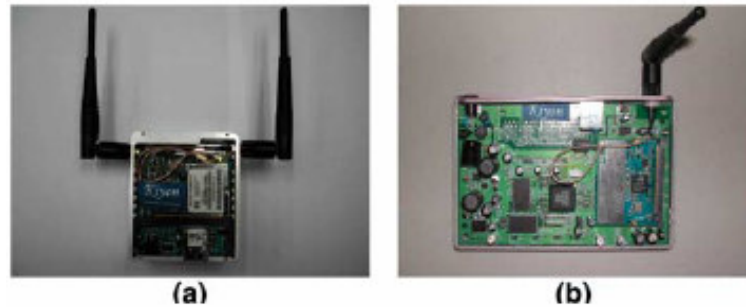
Figura 1-7. Ejemplos de MAPs implementados sobre diferentes sistemas embebidos: (a) Micro Procesador PowerPC y (b) Máquina Risc Avanzada ( Advanced Risc Machine, ARM )
