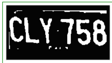
Figura 3.11 Corrección de inclinación.
