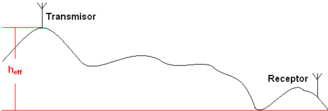
Figura 7. Definición de altura efectiva de la antena.
