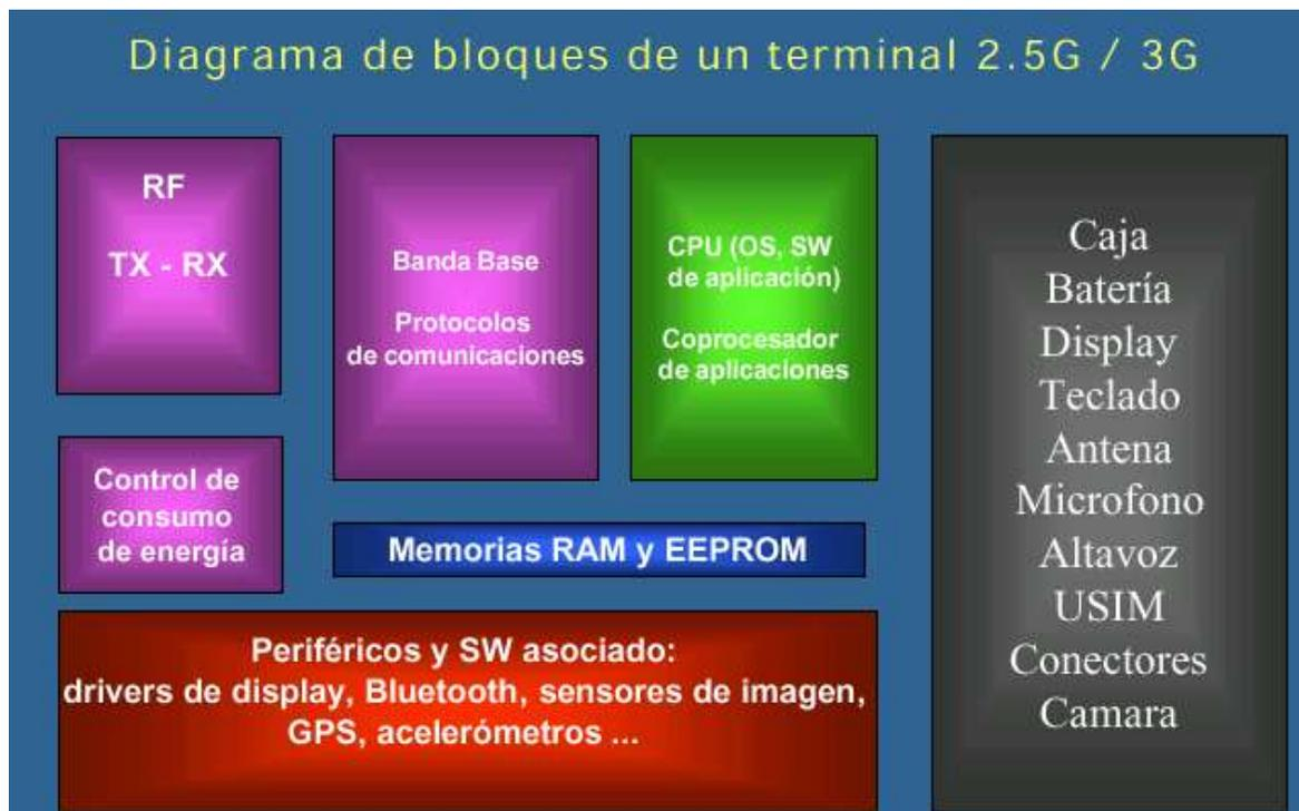
**Figura 2.7. Diagrama en bloques de un terminal 2.5G/3G**
